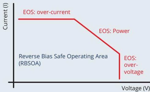
Abbildung 1b: RBSOA: Basis-Emitter-geschalteter externer Bipolartransistor (BJT)
