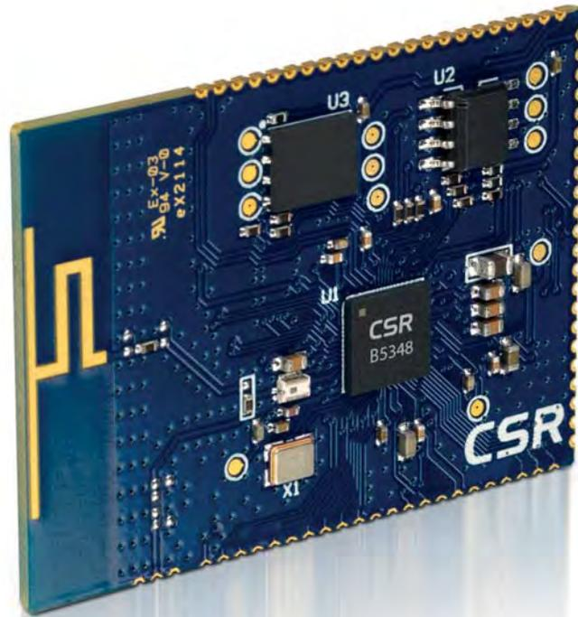
Industrietaugliches Dual-Mode Bluetooth Kommunikations-System-on-Chip (SoC)
