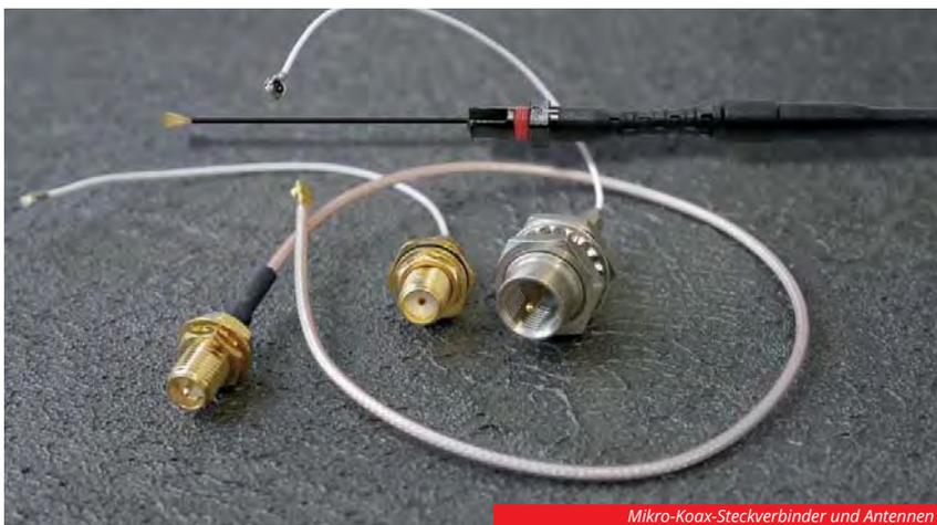
Mikro-Koax-Steckverbinder und Antennen
