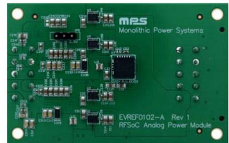
Abbildung 9: Das extrem rauscharme Netzteilmodul EVREF0102
