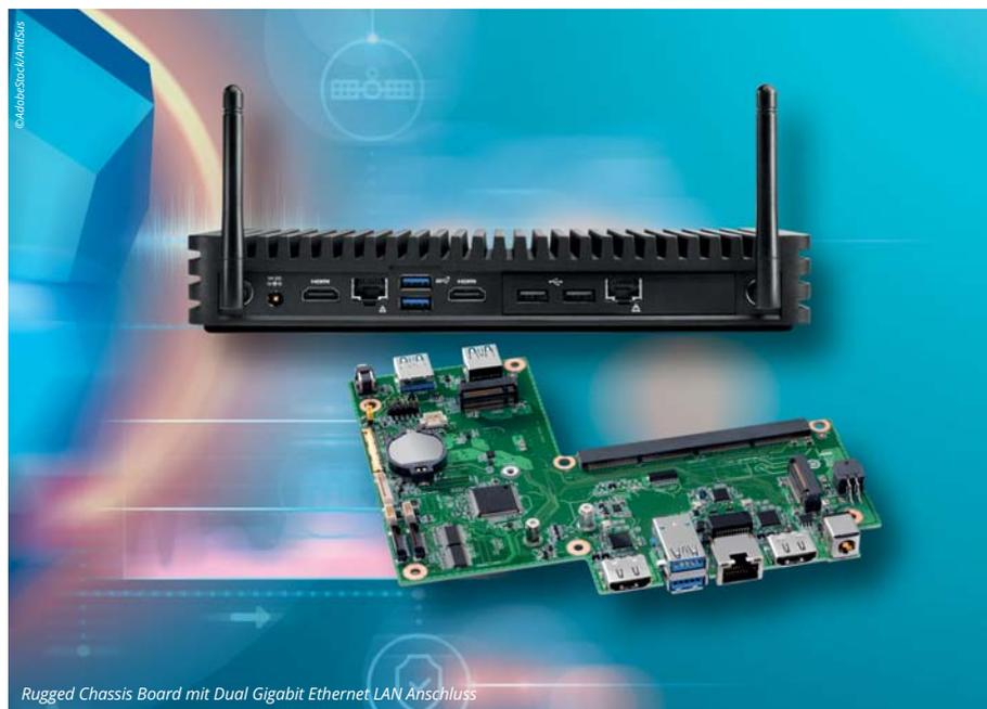
Rugged Chassis Board mit Dual Gigabit Ethernet LAN Anschluss
