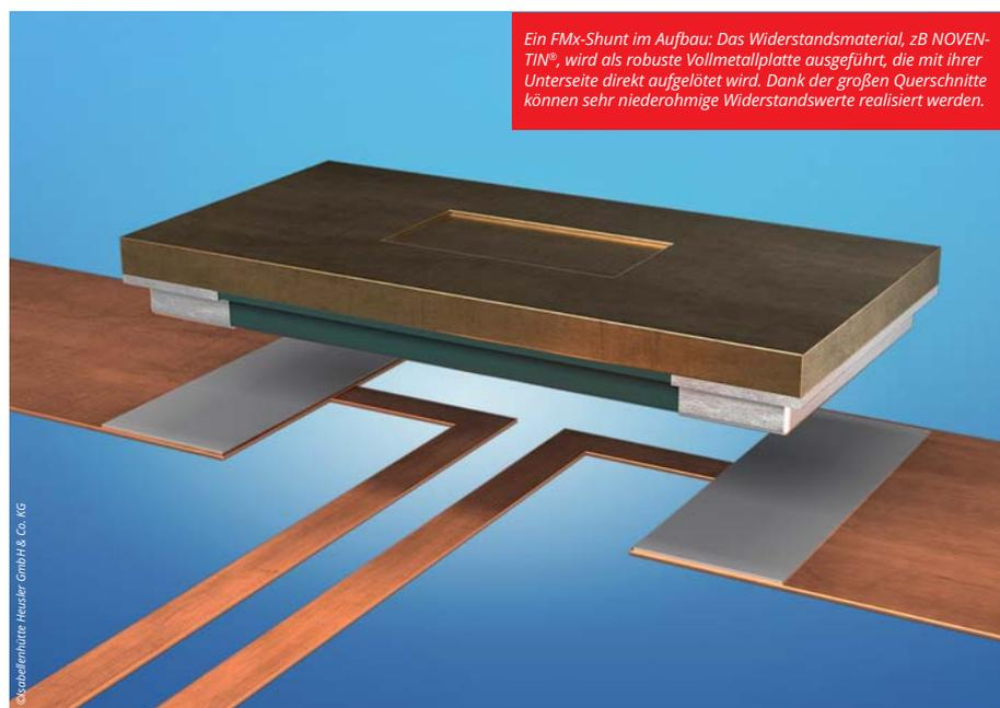
Ein FMx-Shunt im Aufbau: Das Widerstandsmaterial, zB NOVENTIN®, wird als robuste Vollmetallplatte ausgeführt, die mit ihrer Unterseite direkt aufgelötet wird. Dank der großen Querschnitte können sehr niederohmige Widerstandswerte realisiert werden.
