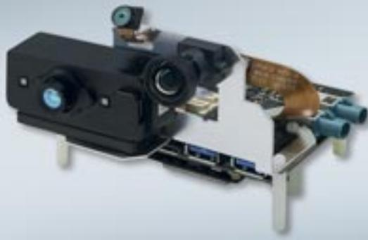
Das RB5-EntwicklungsKit mit Unterstützung für das Kameramodul IMX577 von Sony und Omnivisions Kameramodul OV9282, welches Ortungsanwendungen unterstützt sowie ein Time-Of-Flight-Sensorzubehör von THUNDERCOMM, sind ebenfalls erhältlich.
