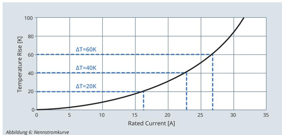
Abbildung 6: Nennstromkurve
