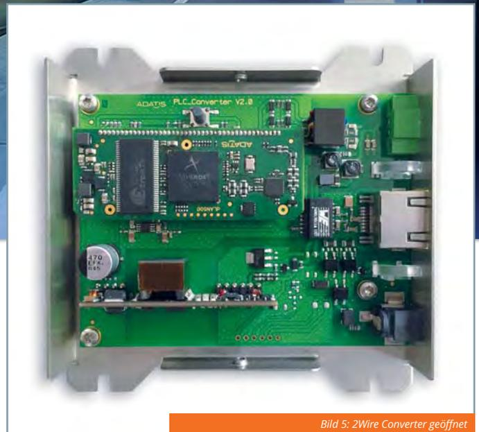
Bild 5: 2Wire Converter geöffnet
