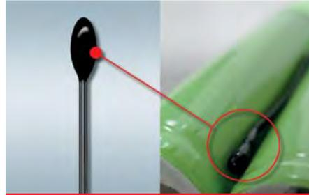
Abb. 5: NTC-Sensor im Miniaturformat und konzeptuelle Montage in zylinderförmigen Batteriemodulen.
