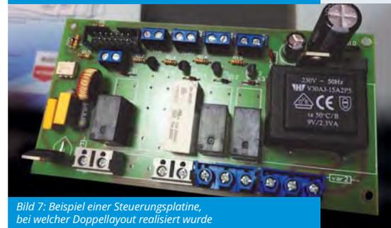
Bild 7: Beispiel einer Steuerungsplatine, bei welcher Doppellayout realisiert wurde
