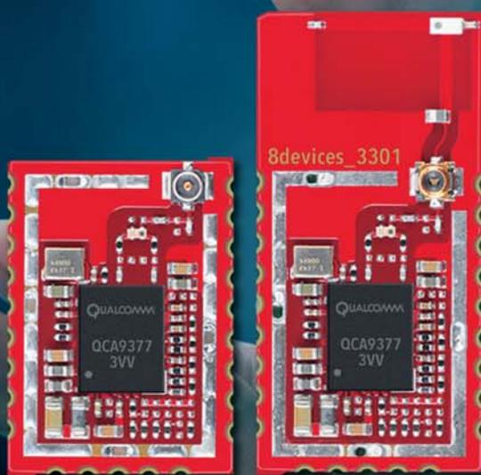
Das neue RED-BEAN Modul von 8DEVICES basiert auf dem QCA9377-3 Radio-Baustein von QUALCOMM und erlaubt die Anbindung von Wi-Fi und Bluetooth Anwendungen an einen Host-Prozessor.
