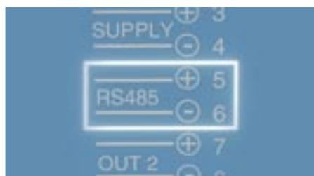
Beim Modbus-RTU handelt es sich um ein offenes, serielles Protokoll, das auf der ursprünglich von Modicon (heute Schneider Electric) entwickelten Master-/Slave-Architektur basiert und aufgrund seiner Benutzerfreundlichkeit und Zuverlässigkeit heute weit verbreitet ist. Modbus RTU kommt sehr häufig in Gebäudemanagement-(BMS) und Industrieautomatisierungssystemen (IAS) zum Einsatz.
