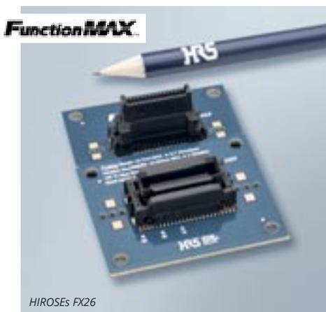
Der Steckverbinder ist mit 20, 30, 40, 50 und 60 Kontaktpositionen erhältlich und es stehen mit 15, 18, 20, 23 und 25mm verschiedene Steckhöhen zur Verfügung. Weitere Varianten sind in Entwicklung.
